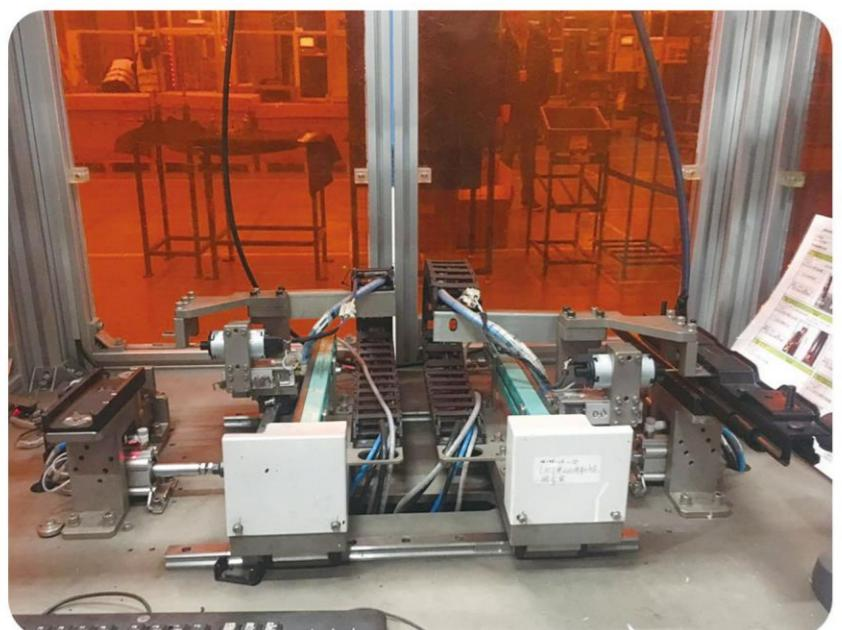
该设备主要完成单只滑轨的质量监控检测，通过操作人员将单只滑轨放到检测设备上，设备可以自动按照设定的动作行程进行检测，可对检测的力值等限定进行设定来达到客户检测指标的要求。。
