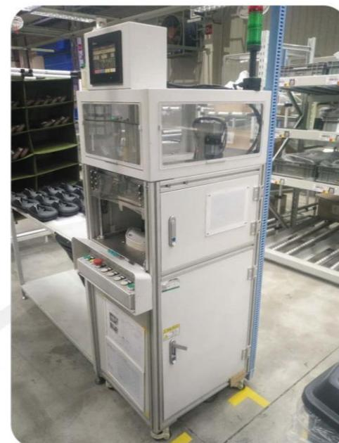
1. 设备压紧装置将头枕罩盖压住，对头枕罩盖上的头枕金属卡子进行探测是否安装到位，同时头枕导杆仿形柱伸出确保金属卡子安装到位，探测设备探测合格后，头枕导杆仿形柱缩回，如不合格，需蜂鸣器报警，需设备复位后重新开始。
